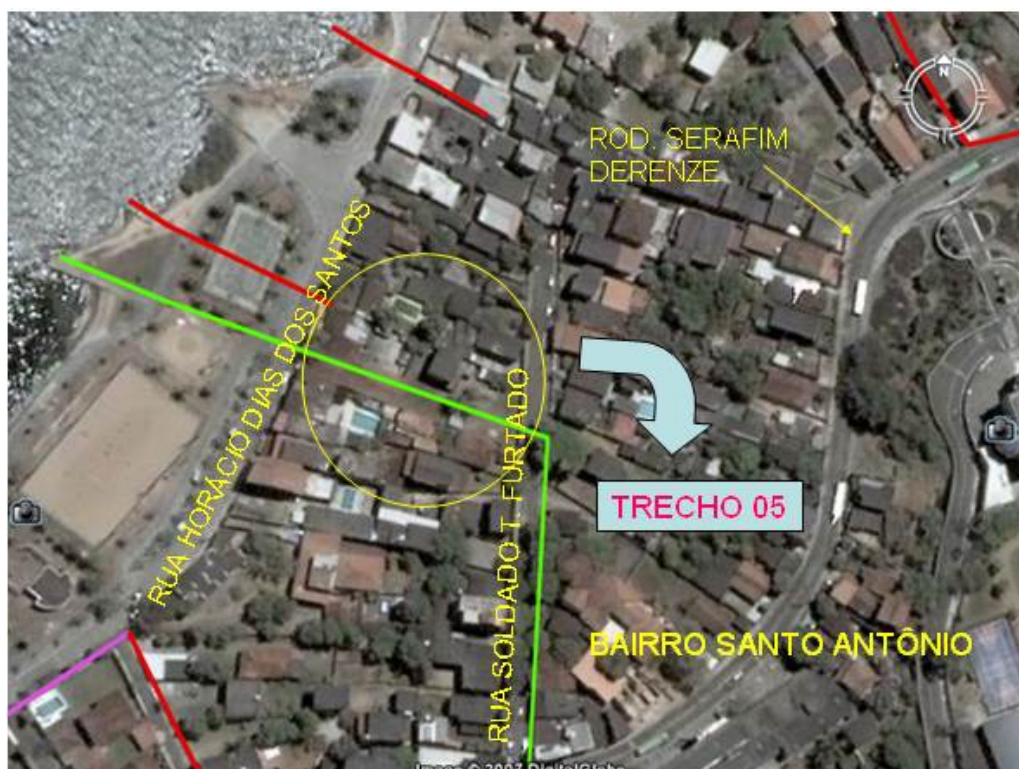
Figura 13: Edificações sobre a rede de drenagem. Trecho 5.
