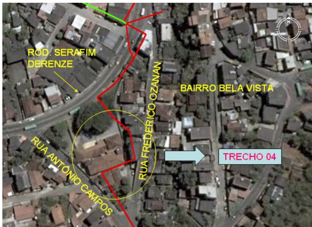
Figura 12: Edificações sobre a rede de drenagem. Trecho 4.
