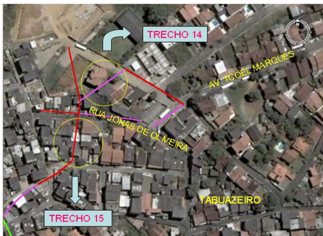
Figura 17: Edificações sobre a rede de drenagem. Trechos 14 e 15.
