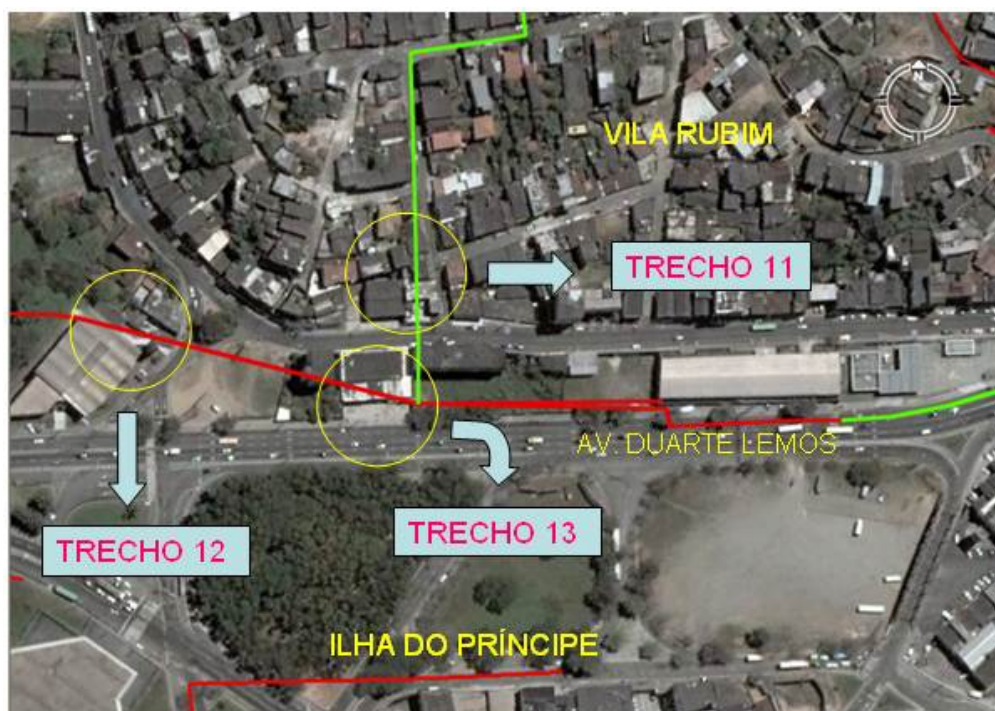
Figura 16: Edificações sobre a rede de drenagem. Trechos 11,12 e 13.
