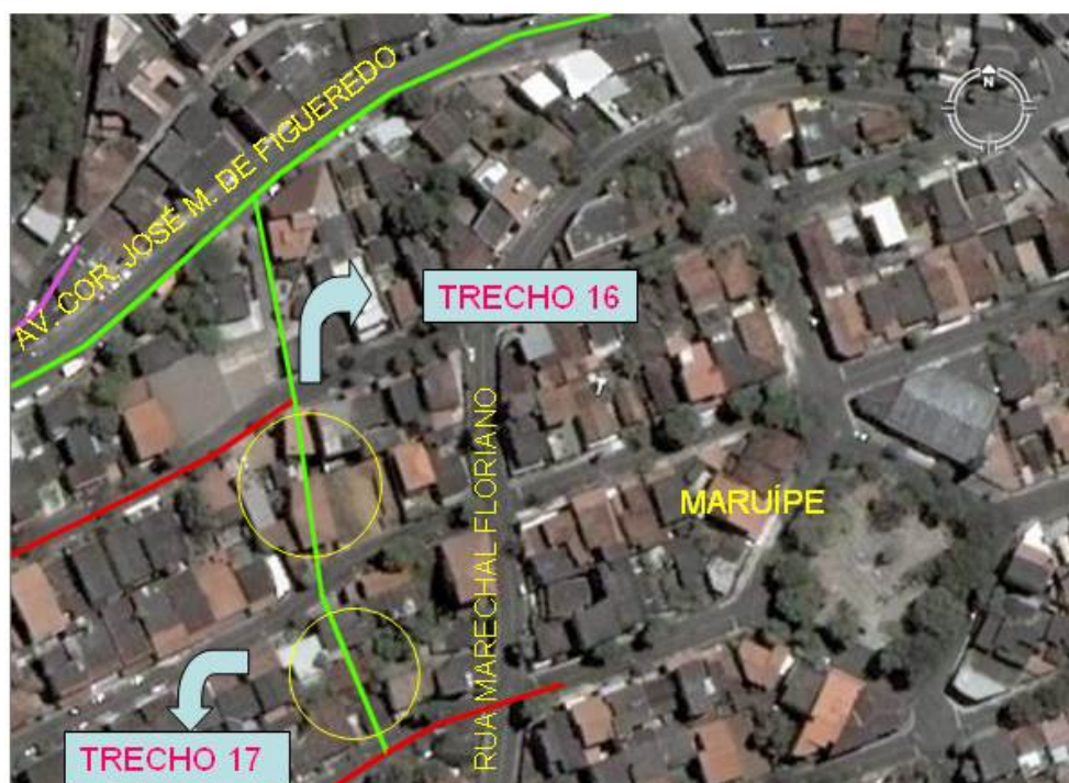
Figura 18: Edificações sobre a rede de drenagem. Trechos 16 e 17.
