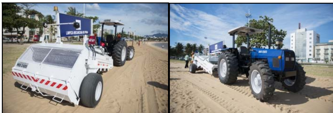
Figura 26: Equipamento de limpeza mecanizada das areias de praias de Vitória.
