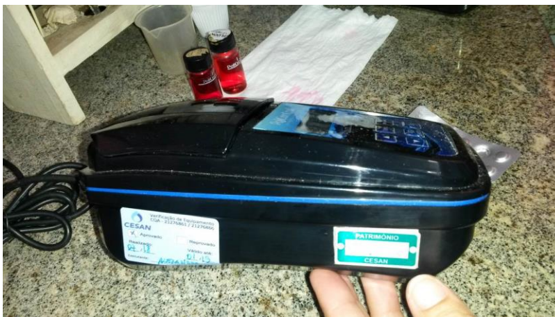
Figura 29 - Colorímetro na ETA Caçaroca.
