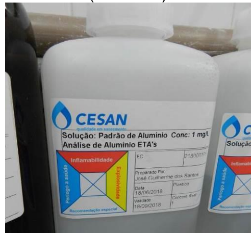
Figura 17 - Solução Padrão de Alumínio (ETA Caçaroca).
