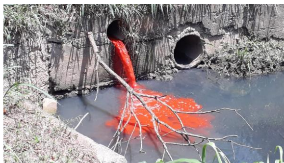
Figura 4 - Esgoto bruto originário do tratamento preliminar da ETE Nova Carapina, com traçador vermelho, sendo lançado na rede de drenagem que se conecta ao Córrego Barro Branco.
