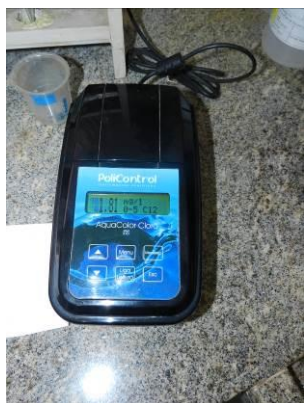
Figura 65 - Equipamento para análise de cloro.
