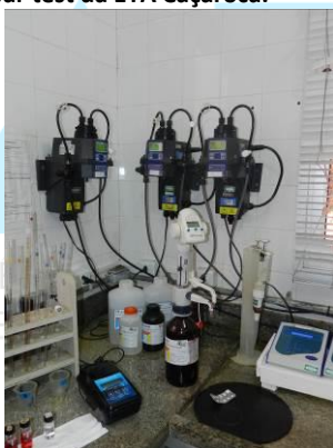
Figura 63 - Leitores de turbidez “on line” da água bruta e após o tanque de contato.
