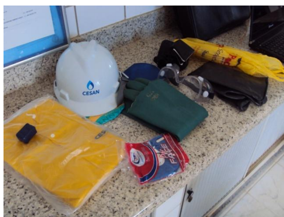
Figura 18: EPIs para os operadores da ETA
