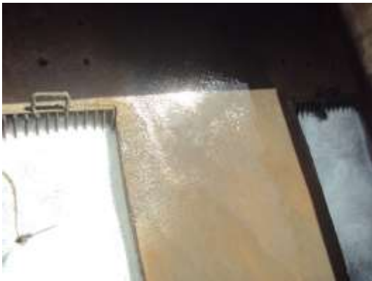
Figura 1 – Mecanismo de remoção de sólidos grosseiros após limpeza.
