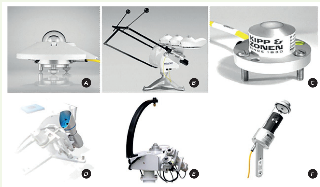
FIGURAS C.1 Equipamentos de medição da irradiação solar, piranômetro e pireliômetro
