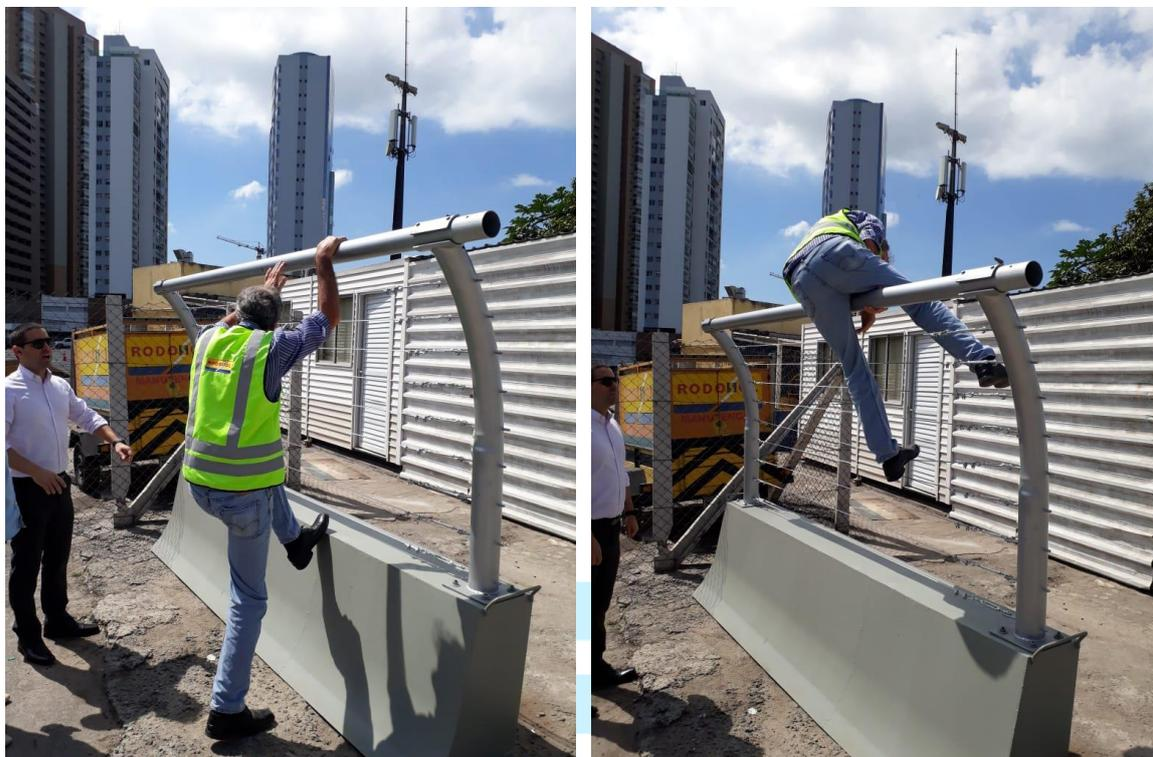
Fotos 1 e 2: Protótipo da tecnologia com cabos de aço horizontais sustentados por barreiras verticais inclinadas.
