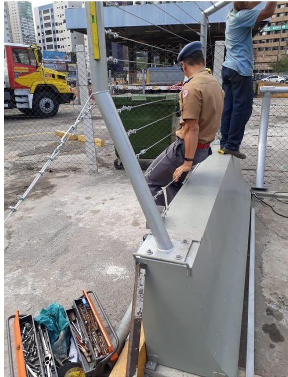
Fotos 3 e 4: Testes de inclinação das barreiras verticais
